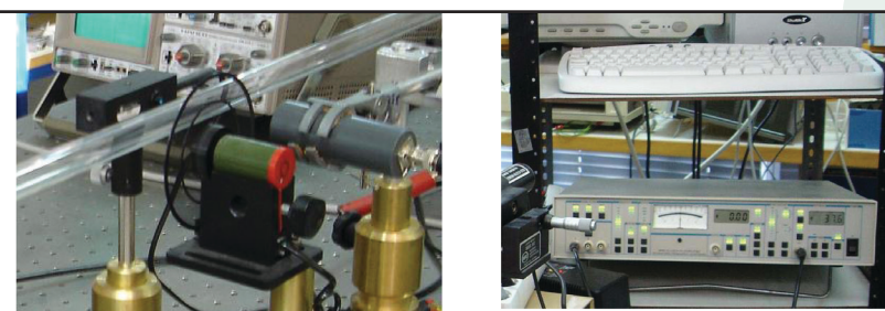
Εκ. 5: Αριστερά: Σύστημα μέτρησης το οποίο αποκαλύπτει από λαζέρ Ηg και σκευή XUV, ενώ στην αριστερά αποκαλύπτει και το σύστημα μετρικής συλλογής σημάτων (detector) το οποίο είναι απαραίτητο για τη μέτρηση με lock-in amplifier. Δεξιά: Σύστημα καταγραφής υψηλών σημάτων τύπου lock-in
