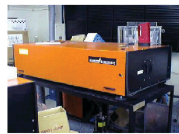
Εκ. 6: Σύστημα καταστροφής όζοντος (Lambda Physik, Excimer Laser ArCf 308 nm, 20 ns)
